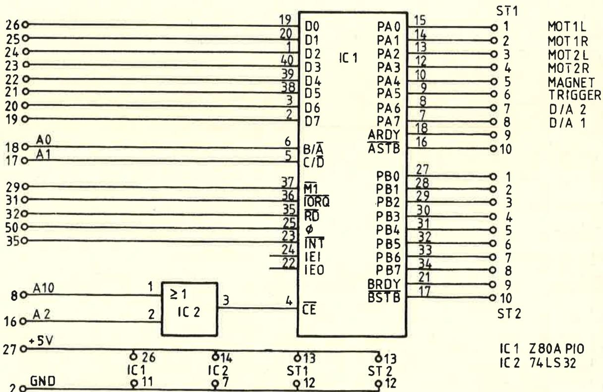
BILD 2 Parallelschnittstelle
