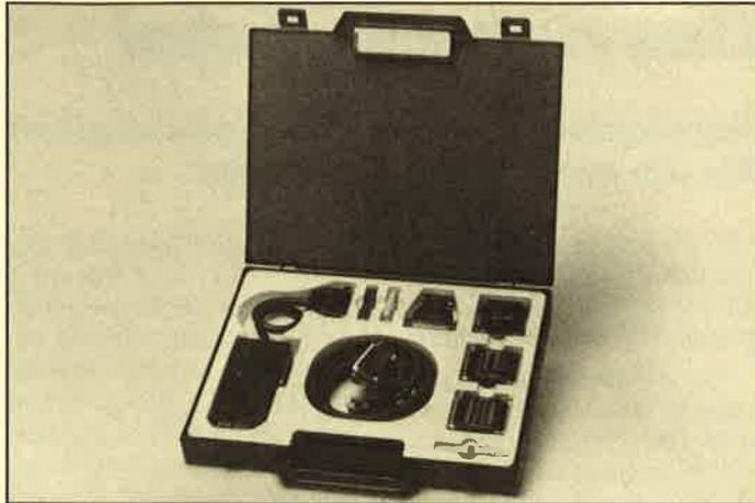
**Das RS232-Interface-Set mit Kabeln, Steckern, Adaptern, Konfigurator und Kabeltester ist in einem handlichen Koffer untergebracht.**
